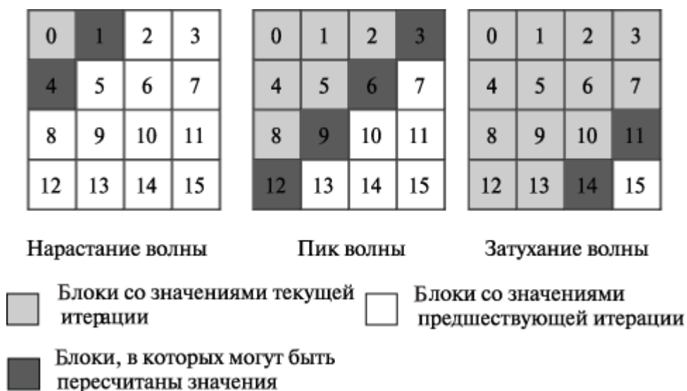
Рис. 13. Организация волны вычислений при блочной схеме разделения данных
